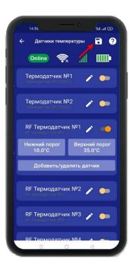
Для добавления беспроводного датчика температуры в прибор, нажмите на кнопку «Добавить/удалить датчик», далее нажмите на кнопку «Добавить» и нажмите «Включить». На датчике температуры нужно нажать на кнопку «ОК», на экране приложения обновится статус на «Добавлен»
