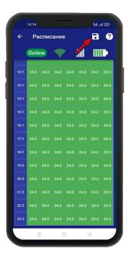
В данном примере, расписание настроено так: С понедельника по воскресенье, с 24:00 и до 10:59 часов, установлена температура  $17^{\circ}$ . Начиная с 11:00 и до 23:59 часов, температура установлена  $24^{\circ}$ .
