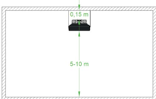
В случае высокой потребности на тепло, возможно установить больше оборудования в помещении. Чтобы обеспечить надлежащий поток воздуха, рекомендуется соблюдать рекомендуемые интервалы между тепловентиляторами, как показано на рисунке ниже.
