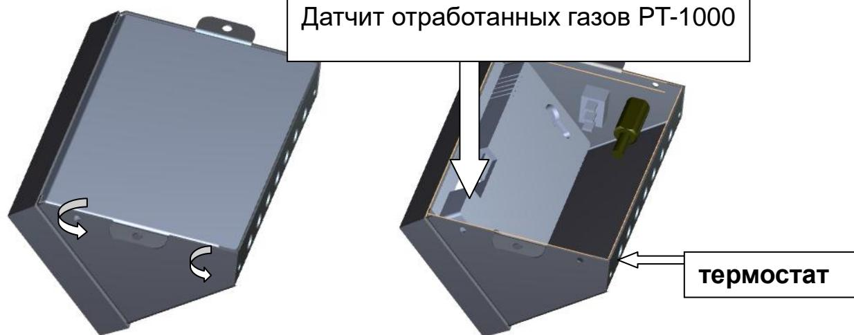
Монтируем проводов к комнатному термостату или к датчику выхлопных газов PID осуществляется при откручивании нижней части контроллера. Провода термостата монтируем в предназначенном месте с помощью зажимов, а датчик выхлопных газов в месте, обозначенном PT1000.
