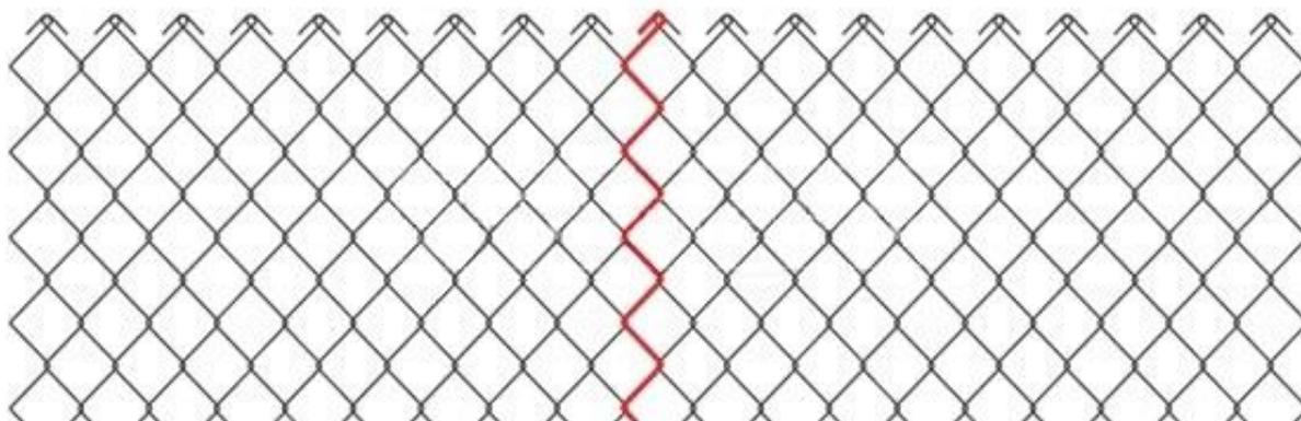
3. Затем соединить правое и левое полотно с помощью выбранной спирали, вплетая ее одновременно в оба полотна вращательным движением (по часовой стрелке или против зависит от производителя, у которого вы купили сетку рабицу):
