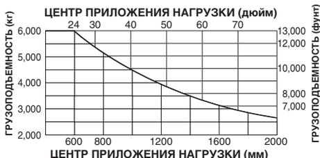
Указанные значения грузоподъемности относятся к погрузчику, оборудованному 2-ступенчатой мачтой с повышенным обзором при максимальной высоте подъема вил 5500 мм (217 дюймов), высоте каретки 1700 мм (66,9 дюйма), высоте вил 1220 мм (48 дюймов). Относительно информации о грузоподъемности погрузчиков с другим оборудованием обращайтесь к региональному дистрибьютору или дилеру.
