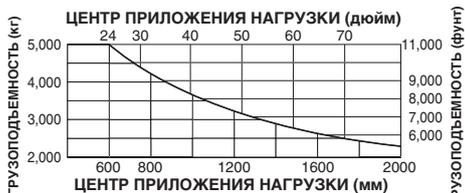
Значения грузоподъемности показаны для погрузчика, оборудованного 2-ступенчатой мачтой с повышенным обзором при максимальной высоте подъема вил 5000 мм, каретки 1700 мм, высоте каретки 1700 мм, высоте вил 1220 мм. Относительно информации о грузоподъемности погрузчиков с другим оборудованием обращайтесь к региональному дистрибьютору или дилеру.
