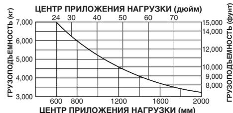
Значения грузоподъемности показаны для погрузчиков, оборудованных 2-ступенчатой мачтой с повышенным обзором при максимальной высоте подъема вил 5000 мм, каретки 1700 мм, высоте каретки 1700 мм, высоте вил 1220 мм. Относительно информации о грузоподъемности погрузчиков с другим оборудованием обращайтесь к региональному дистрибьютору или дилеру.
