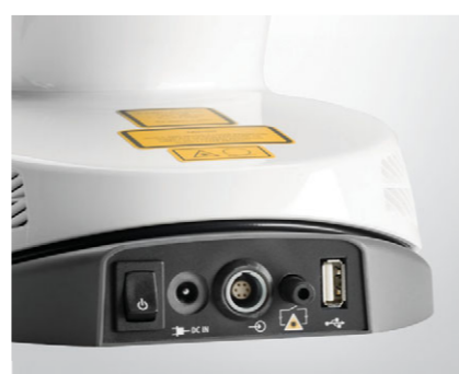
Использование сетевых возможностей Обновление программного обеспечения через USB-порт и блокировочный коннектор.
