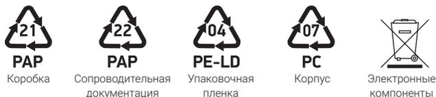
Рисунок 8.1 — Коды утилизации отдельных частей продукта
