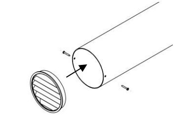
Поместите трубу из вспененного полиэтилена в пластиковый канал.
