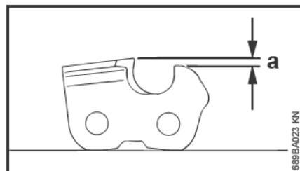
Ограничитель глубины определяет глубину врезания в древесину, т.е. толщину стружки.
