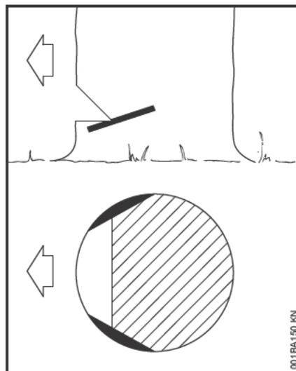
У длинноволокнистой древесины заболонные резы предотвращают разрыв заболони при падении ствола – запиливание производить с обеих сторон ствола на уровне основания подпила на глубину приблизительно  $1/10$  диаметра ствола – у толстых стволов максимально на ширину направляющей шины.
