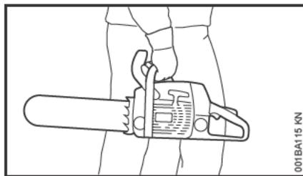
Бензопилу переносить, держа только за трубчатую рукоятку – горячий глушитель держать в сторону от тела, направляющая шина направлена назад. Не дотрагиваться до горячих деталей агрегата, в особенности до поверхности глушителя – опасность ожога!
