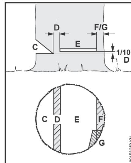
**Подпил (C)** определяет направление валки дерева.
