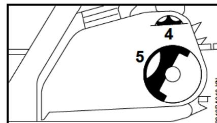
При насаживании крышки цепной звездочки зубья натяжного колеса и натяжного шкива должны зацепляться друг с другом, при необходимости,
