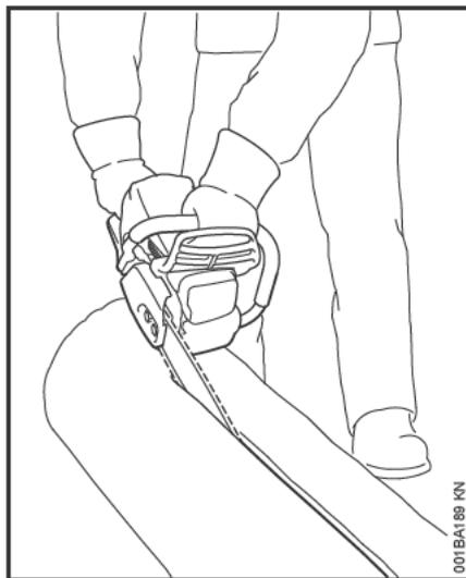
Техника пиления без использования зубчатого упора – опасность вытягивания – направляющую шину устанавливать под как можно более плоским углом – работать особенно осторожно – повышенная **опасность обратного удара!**
