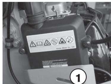
Удалить крышку воздушного фильтра (1).
