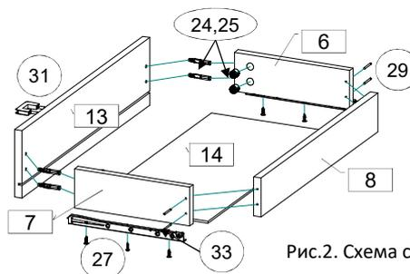
Рис.2. Схема сборки ящика
