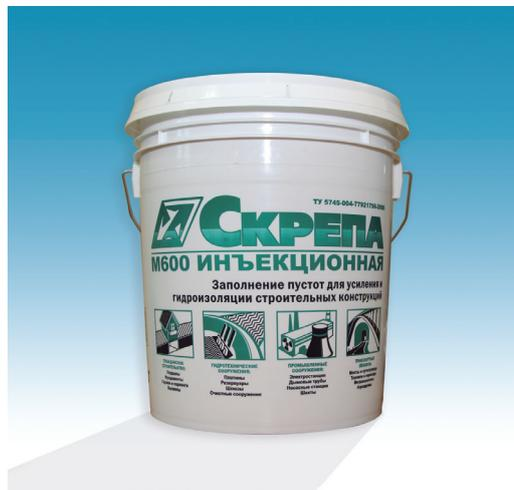
НАЗНАЧЕНИЕ: Используется для заполнения швов, трещин с раскрытием более 0,4 мм, пустот и полостей в строительных конструкциях с целью их гидроизоляции и/или усиления. Применяется как вяжущее для изготовления высокопрочных, водонепроницаемых, безусадочных бетонов и растворов. Может применяться для закрепления анкеров.
