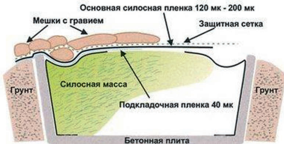
Рисунок 4.2.6 – Схема силосной ямы
