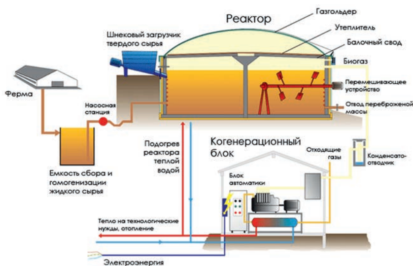
Рисунок 4.5.3 – Принципиальная схема работы биогазовой установки
