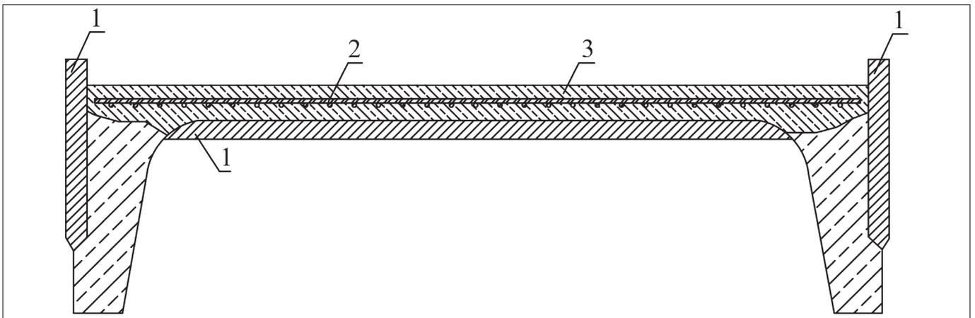
Рисунок 18 – Восстановление плиты в сжатой зоне
