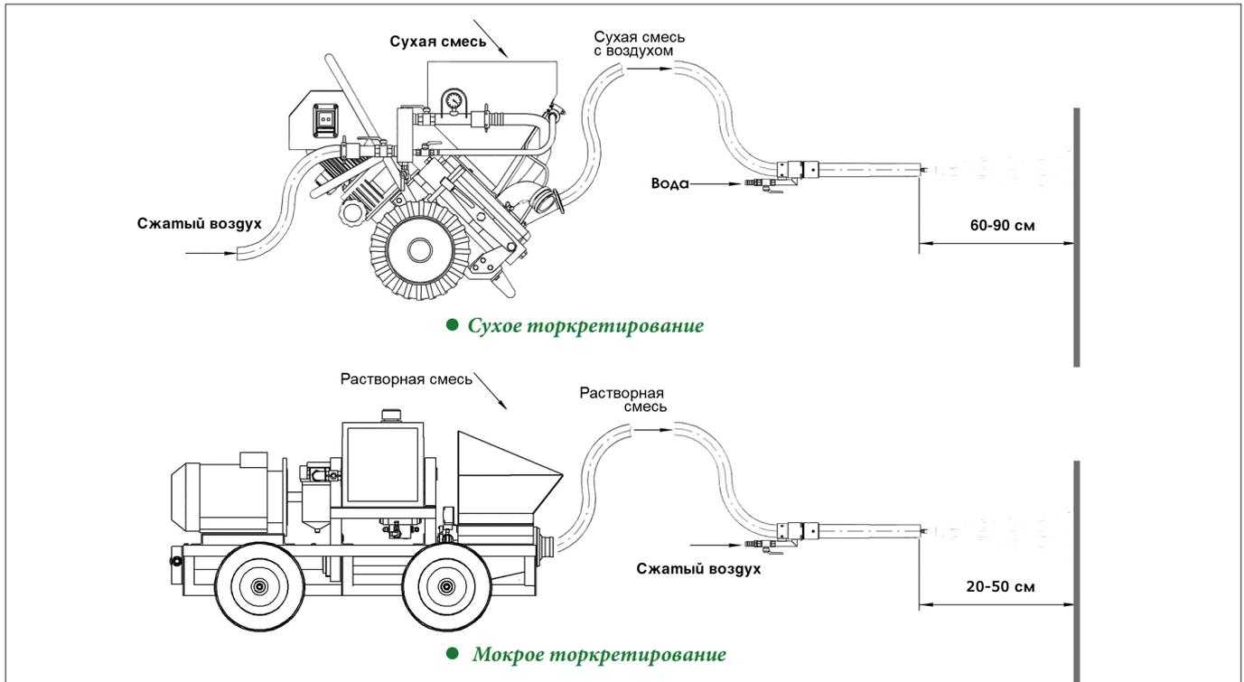
Рисунок 23 – Технологическая схема сухого и мокрого торкретирования
