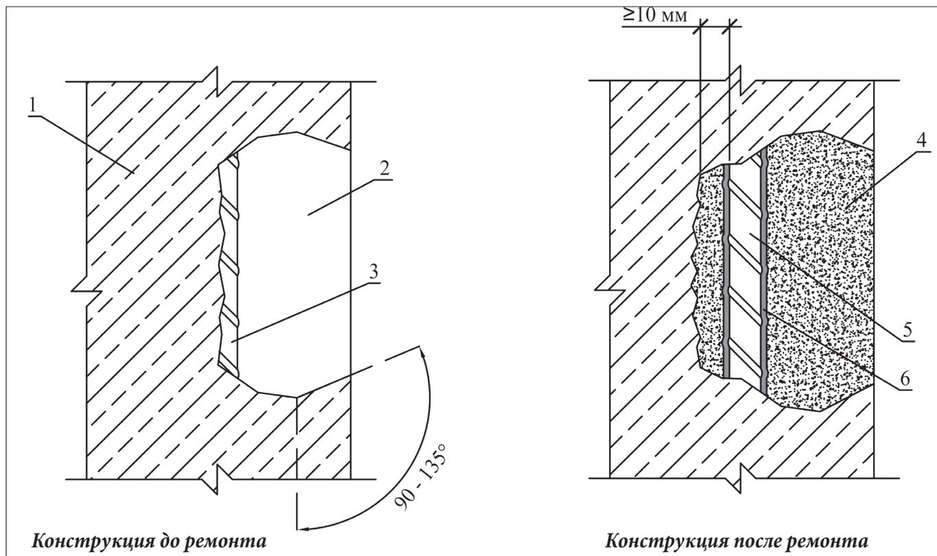
Рисунок 5 – Схема восстановления защитного слоя бетона
