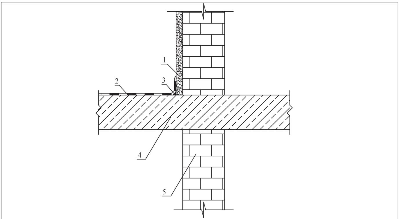
Рисунок 14 – Схема гидроизоляции санитарно-технических узлов
