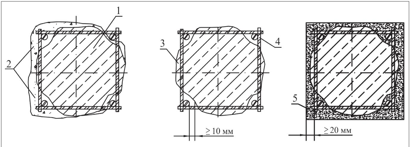
**Рисунок 6 – Схема восстановления железобетонных колонн**
