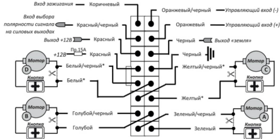
\* Пояснение: Каналы С и D используются только в модулях PWM-4.
