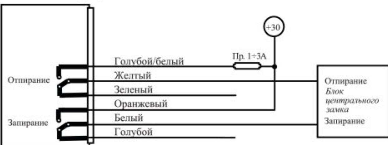
Подключение дополнительного канала 1 для реализации функции «Поддержка зажигания/Турботаймер»:
