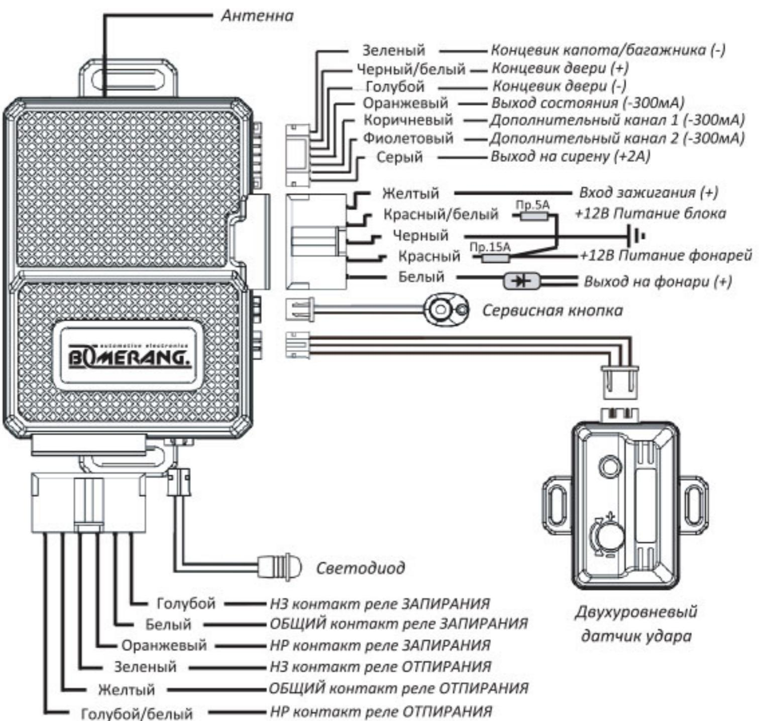
Подключение дополнительного канала 2 для реализации функции «Закрытие стекол при постановке на охрану»
