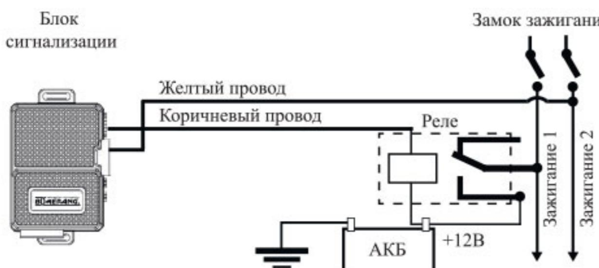
**Подключение нормально разомкнутого реле блокировки**
