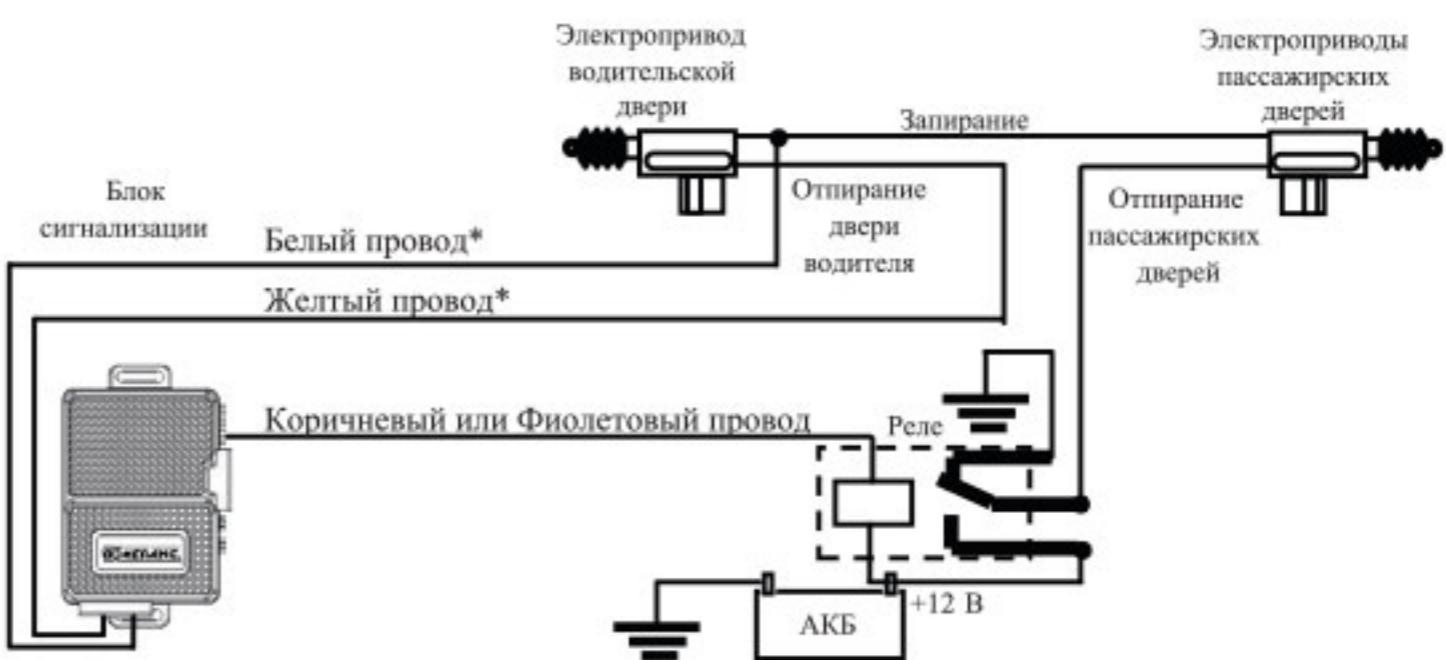
\* Полную коммутацию реле управления центральным замком см. на Схемах подключения к центральному замку
