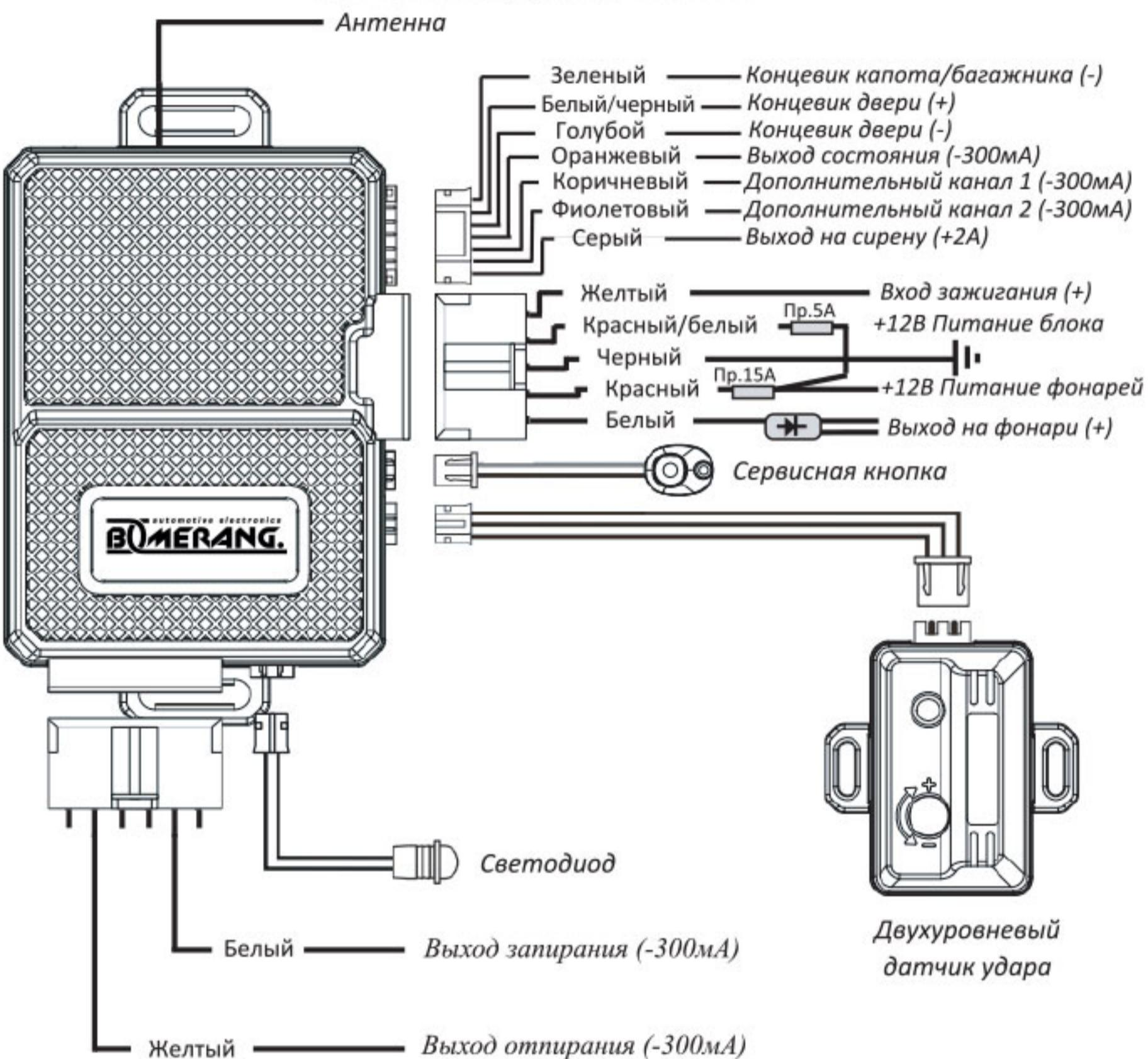
**Назначение проводов и разъемов центрального блока.**
