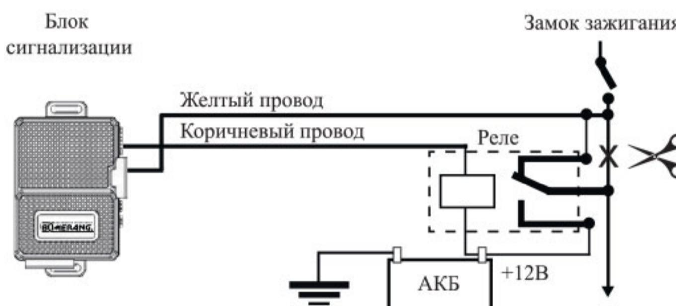
б) при наличии в автомобиле проводов Зажигание 1 и Зажигание 2
