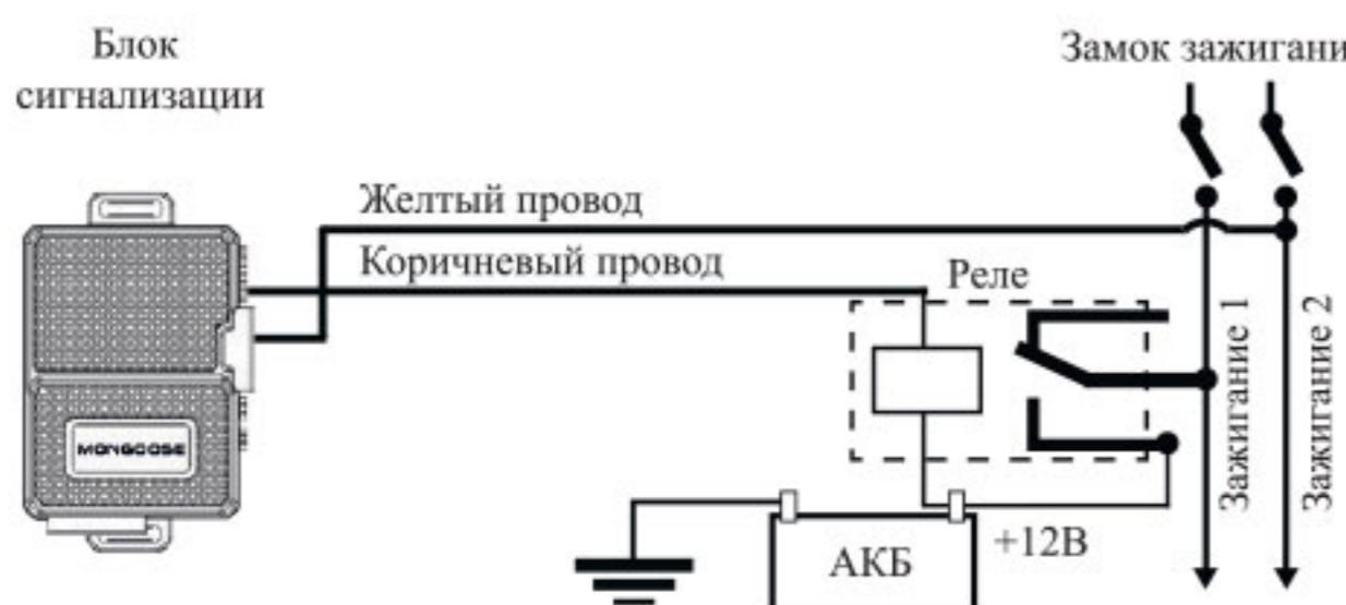
**Подключение нормально разомкнутого реле блокировки**
