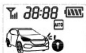
Режим включается перемычкой №3 на блоке сигнализации. Если режим включен ( заводская установка), на дисплее пульта будет отображаться соответствующий индикатор. Перемычкой №4 можно включить или выключить ( заводская установка) запирание дверей при автоматической постановке на охрану.
