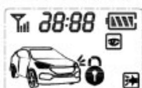
Нажмите на пульте кнопку . Светодиодный индикатор на блоке связи начнёт мигать двойными вспышками, прозвучит один звуковой сигнал, габариты вспыхнут один раз, замки дверей закроются (если замки подключены к сигнализации).
