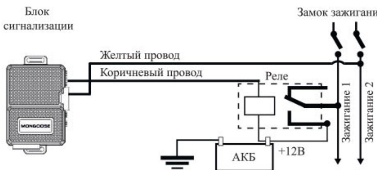
**Подключение нормально разомкнутого реле блокировки**
