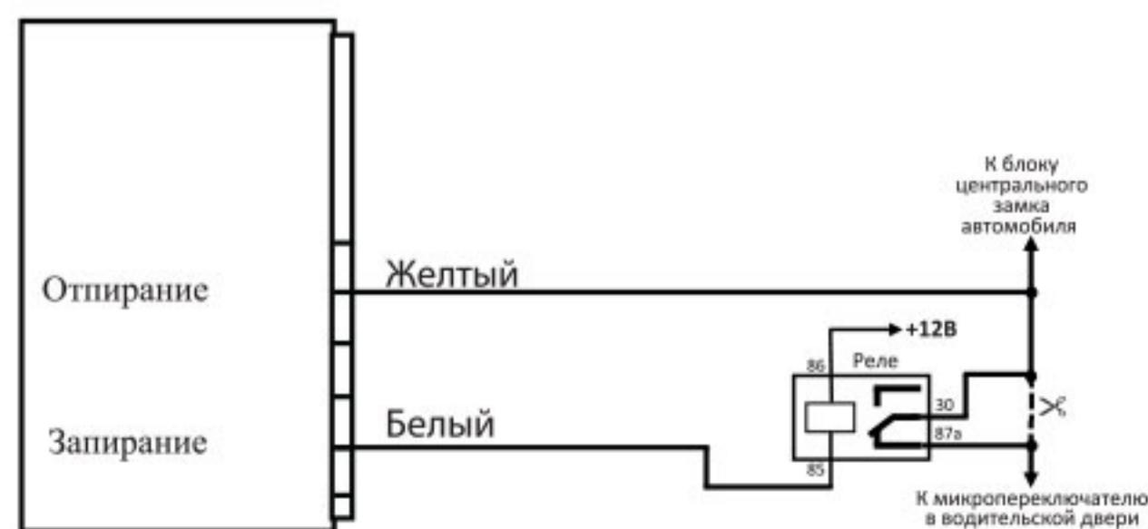
**Подключение дополнительного канала 2 для реализации функции «Закрытие стекол при постановке на охрану»**
