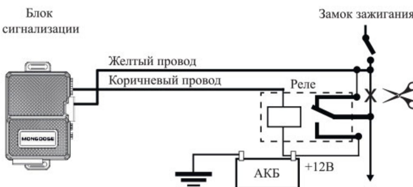
b) при наличии в автомобиле проводов Зажигание 1 и Зажигание 2
