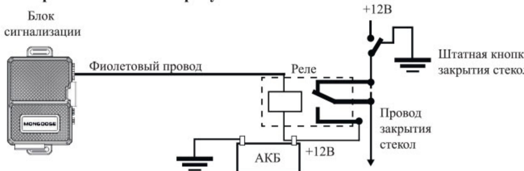
**Подключение дополнительного канала 1 для реализации функции «Поддержка зажигания/Турботаймер»:**
