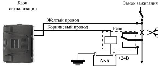
б) при наличии в автомобиле проводов Зажигание 1 и Зажигание 2
