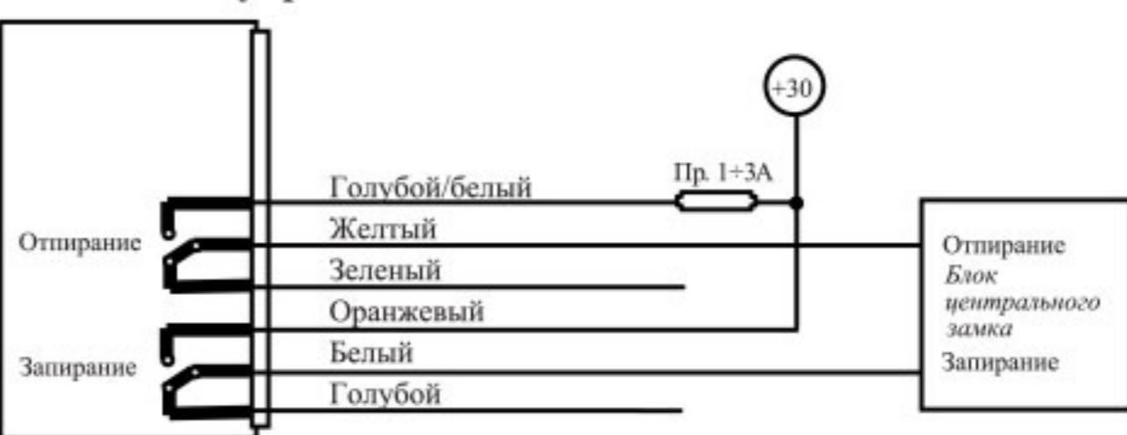
Подключение дополнительного канала 1 для реализации функции «Поддержка зажигания/Турботаймер»:
