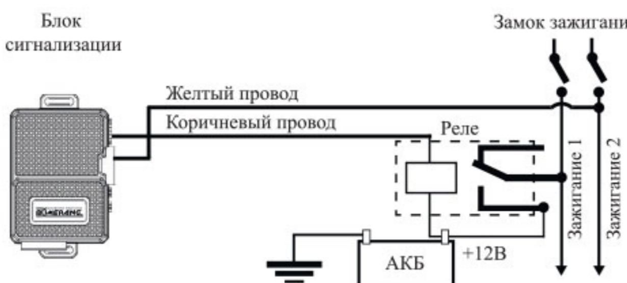
Подключение нормально разомкнутого реле блокировки
