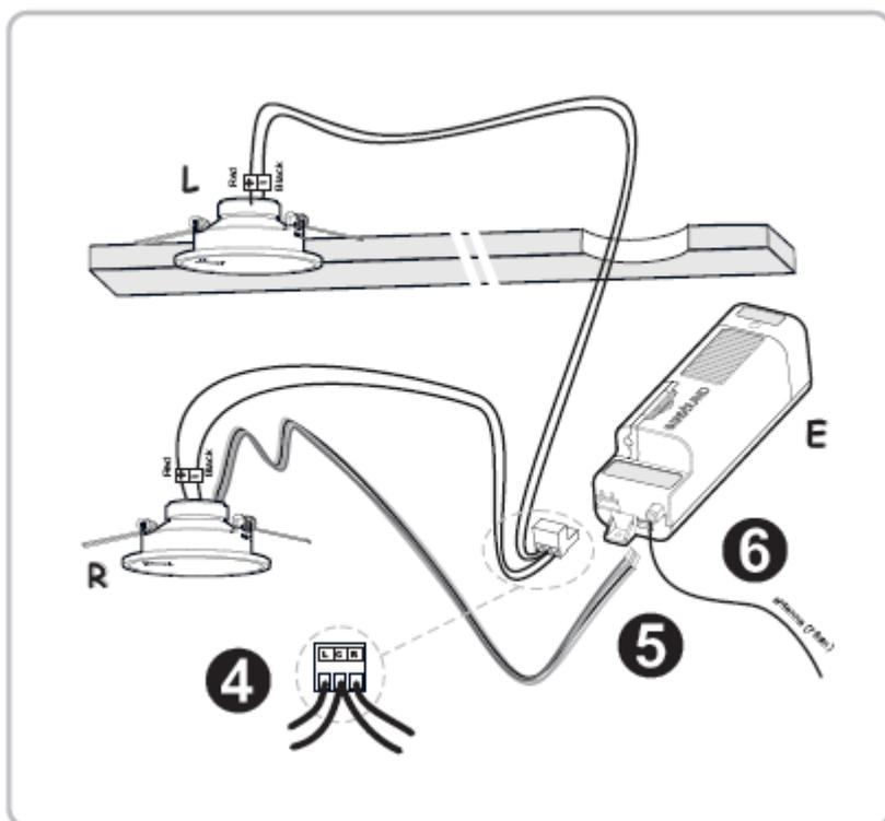
4 Соедините динамики R и L с кабельными входами L, C и R - для электронного модуля E.
