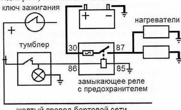
Контакт реле 86 (белый провод из колодки реле с коннектором (типа WAGO)) подсоедините к первому контакту тумблера (провод с коннектором (типа WAGO)). Если длины проводов недостаточно, то удлините их, используя Провод из набора.
