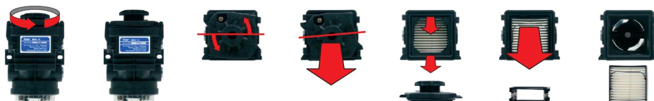
Отвинтить сверху зажимное приспособление крышки фильтра.
