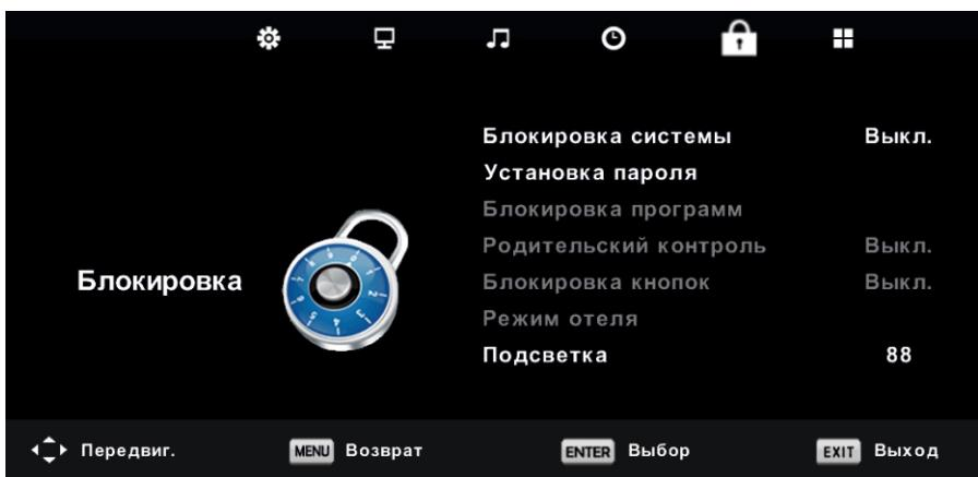
В разделе **БЛОКИРОВКА** включается режим блокировки каналов и источников сигнала («ТВ-замок»), а также родительский контроль.
