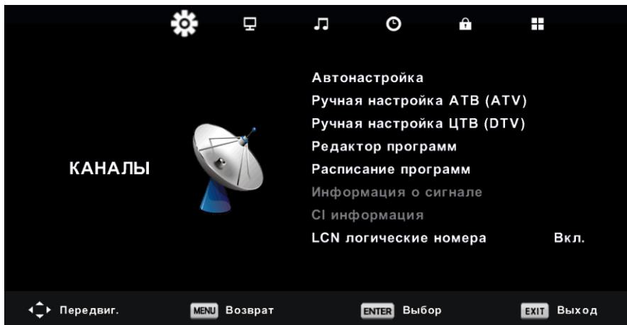
Для переключения ТВ в режим приема **цифрового кабельного телевидения DVB-C** войдите в подменю «Автонастройка» и в пункте «Цифровой тип» выберите «DVB-C». Для переключения ТВ в режим приема **цифрового эфирного телевидения DVB-T2** войдите в подменю «Автонастройка» и в пункте «Цифровой тип» выберите «DVB-T2».
