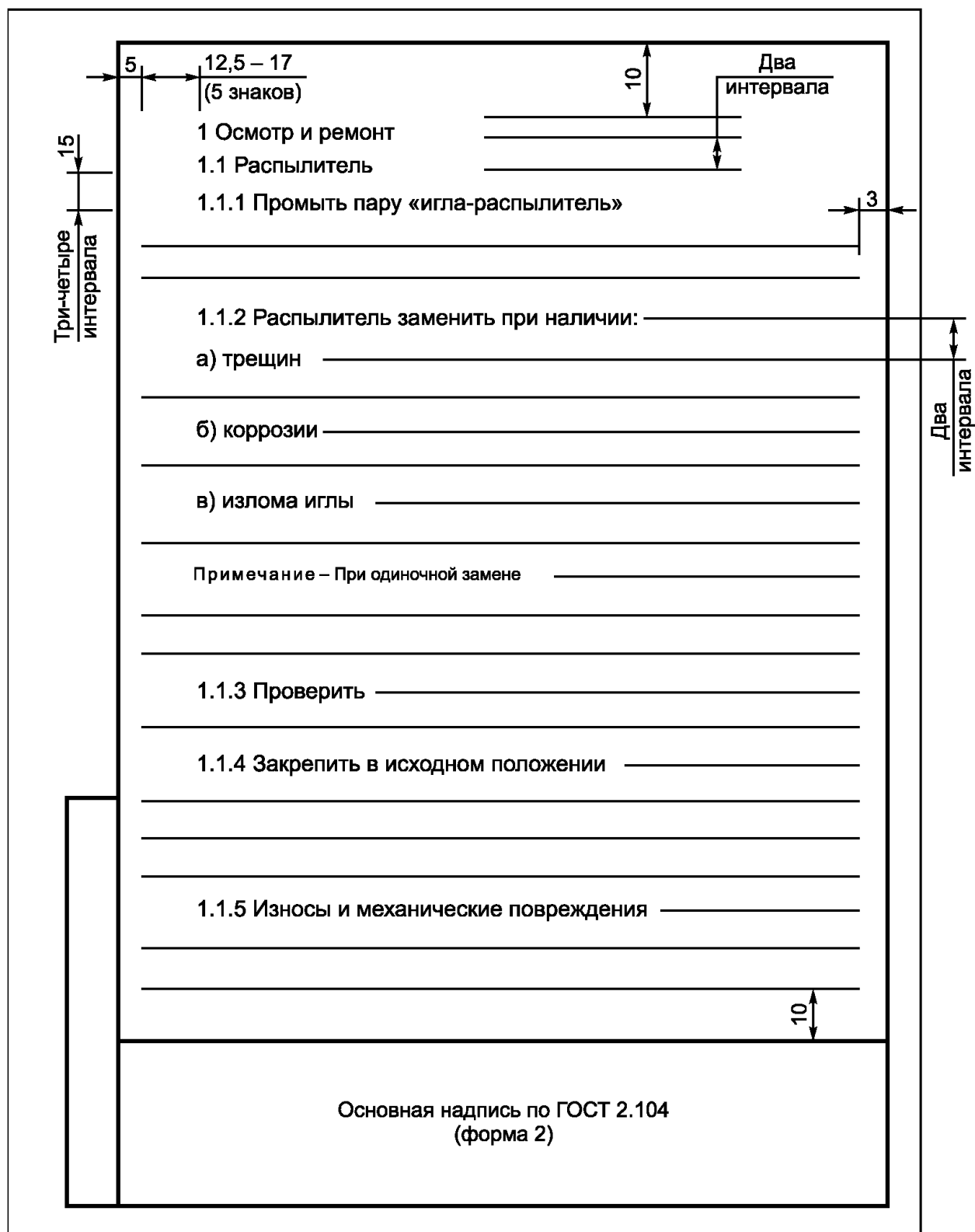
Рисунок А.1 - Пример выполнения первого нумеруемого листа ТД с основной надписью
