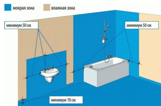
Схема устройства гидроизоляции стен и полов
