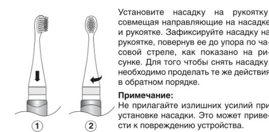
Установите насадку на рукоятку, совмещая направляющие на насадке и рукоятке. Зафиксируйте насадку на рукоятке, повернув ее до упора по часовой стрелке, как показано на рисунке. Для того чтобы снять насадку, необходимо проделать те же действия в обратном порядке.
