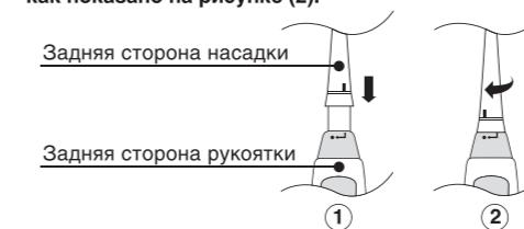
Фиксация насадки происходит в момент совмещения отметок «тире» на задней стороне насадки и «точка» на задней стороне ручки.
