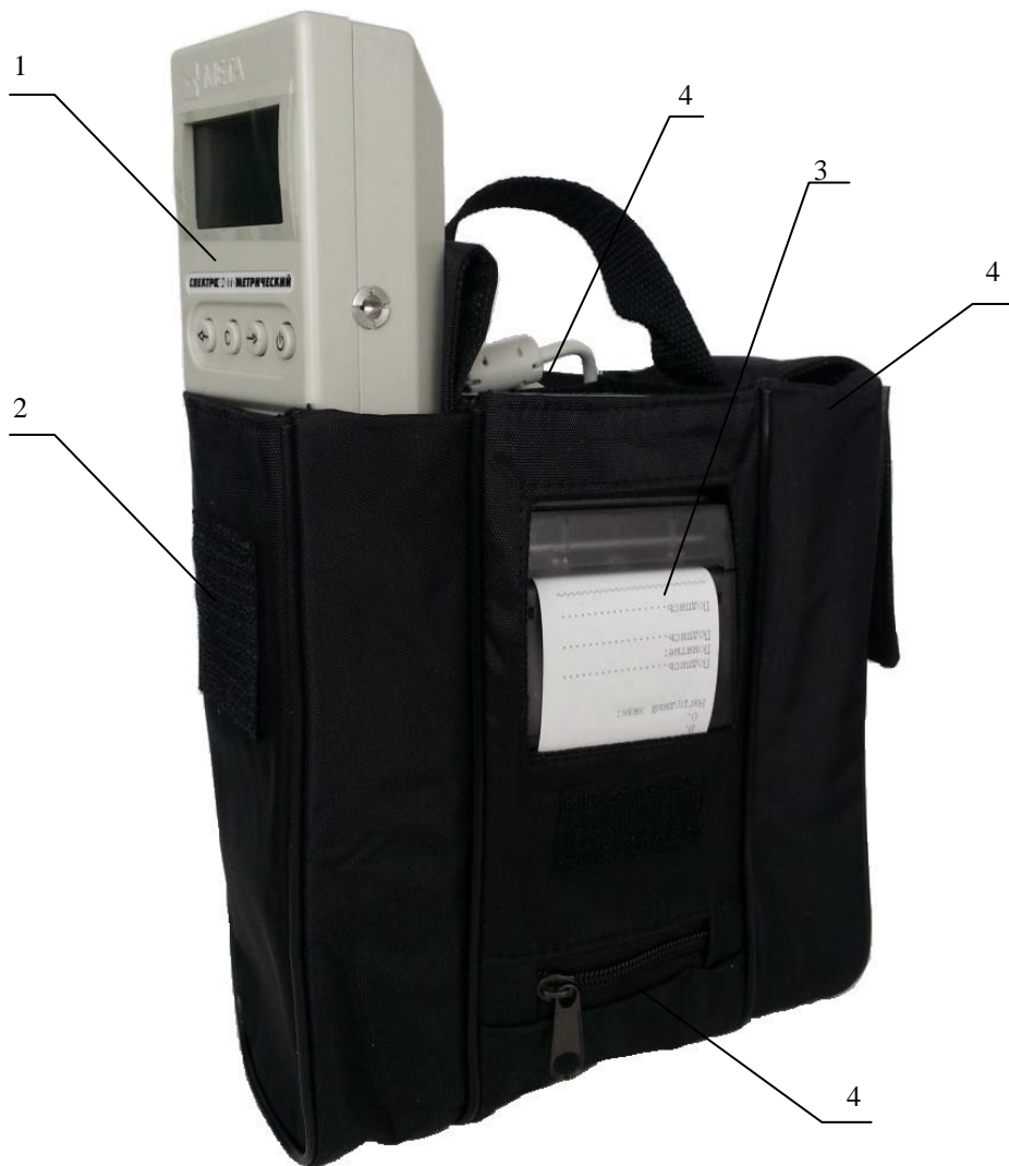
1–Блок измерительный; 2–Футляр (тканевая сумка); 3– Принтер; 4– Карманы для укладки принадлежностей.
