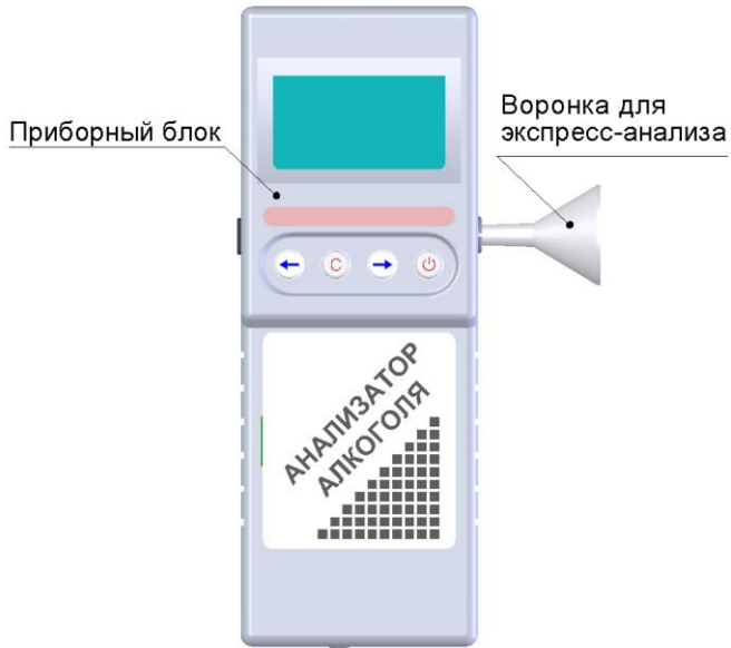
Рисунок 4 – Приборный блок с воронкой для бесконтактного экспресс-анализа
