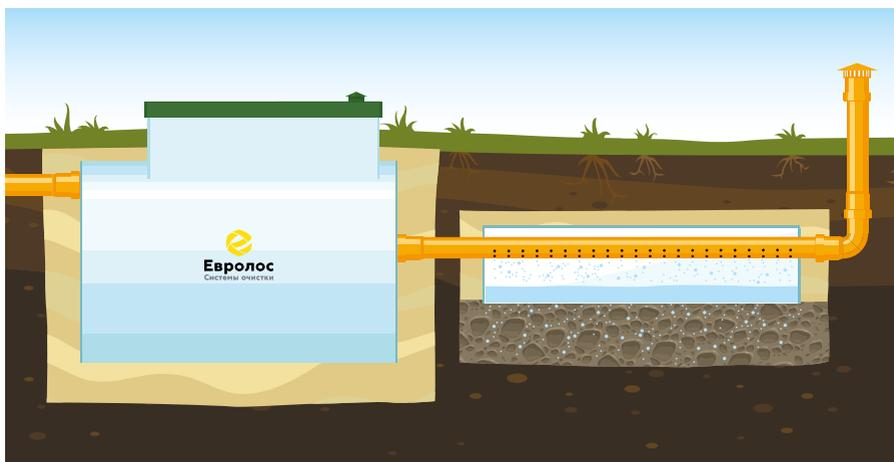
**Вариант 4:** Монтаж с отводом очищенной воды в дренажный элемент. Подходит для хорошо впитывающих грунтов (песок, супесь) и низким уровне грунтовых вод.
