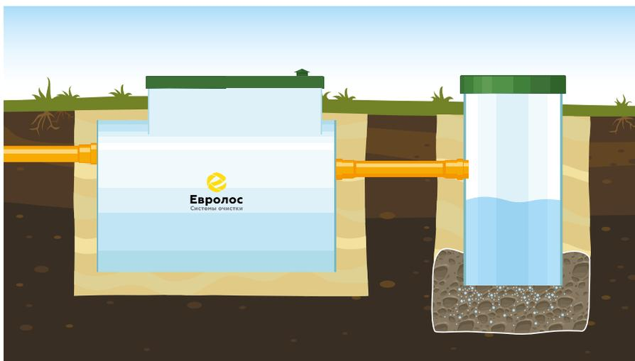
**Вариант 3:** Монтаж с отводом очищенной воды в фильтрующий колодец. Подходит для хорошо поглощающих грунтов (песок, супесь) и низким уровне грунтовых вод.
