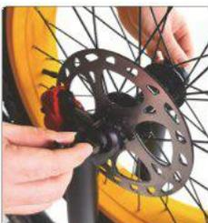
Затяните пружину и гайку на винте
