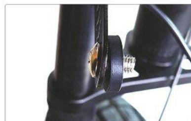
Закрепите резьбовые соединения на вилках
