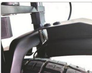
Совместите отверстия для винтов в крыле с отверстиями для винтов в верхней части вилки
