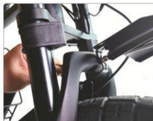
Закрепите гайку гаечным ключом и затяните другой конец шестигранником.
