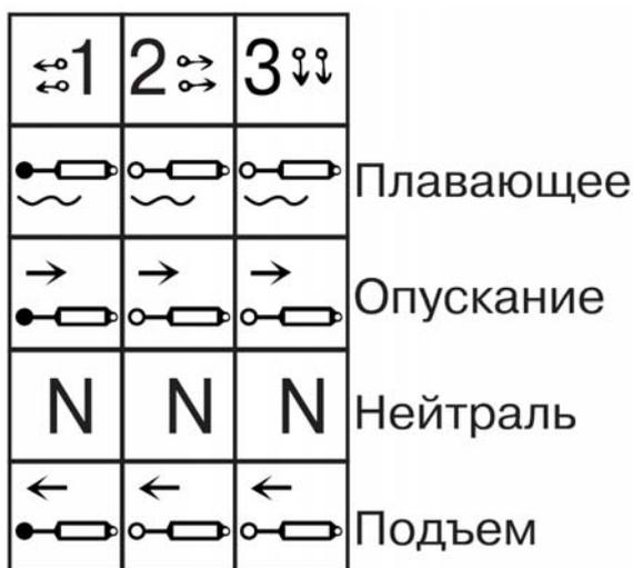
**3.11.2 Управление гидроподъемником ЗНУ** осуществляется двумя рычагами, которые установлены на пульте с правой стороны оператора.
