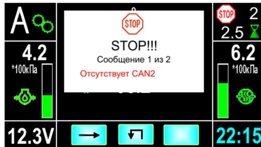
Рисунок 2.5.10 – Пример отображение критической неисправности
