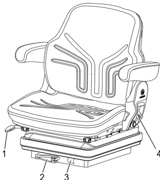
1 – рукоятка продольной регулировки; 2 – рукоятка регулирования по массе; 3 – индикатор регулирования сиденья по массе 4 – рычаг регулировки наклона спинки.
