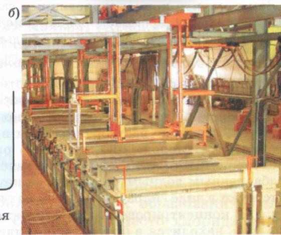
**Рис. 115.** Очистка меди гальваническим рафинированием: а — схема электролизёра; б — медные аноды перед погружением в гальваническую ванну
