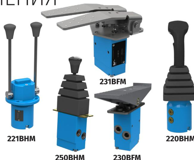
В блоках гидроуправления серии 200ВН применены новые принципы распределения жидкости и регулирования давления и потока. Конструкция является универсальной для различного количества золотников, может быть модульной и секционной. Корпус блока из высокопрочного чугуна является одновременно направляющей для золотников, что улучшило их центрирование, увеличило срок их службы и позволило достичь стабильной работы блока управления с давлением на входе до 100 кгс/см<sup>2</sup>.
