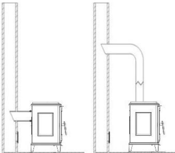
Печь должна размещаться на невоспламеняемом основании достаточной несущей способности. Если основание не соответствует весу печи, то следует предпринять соответствующие меры для повышения несущей способности основания (например, использовать плиты, которые распределяют нагрузку по большей площади). Отдельно стоящая печь должна подключаться к отдельному дымоходу для отработанных газов.
