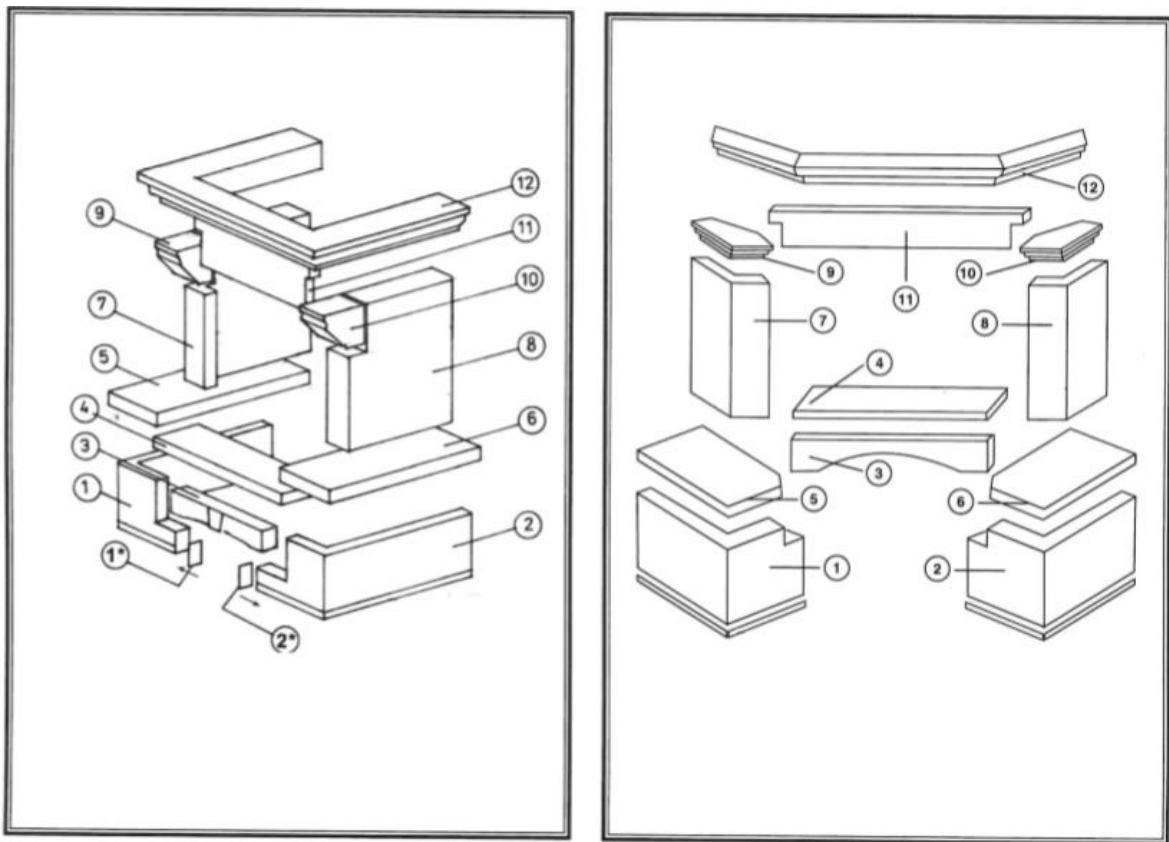
9. В случае использования дополнительной системы распределения горячего воздуха на топке, на боковых плитах необходимо установить боковые опоры облицовки – элементы 7 и 8. Монтируем их таким же самым образом, как и элементы 1 и 2.
