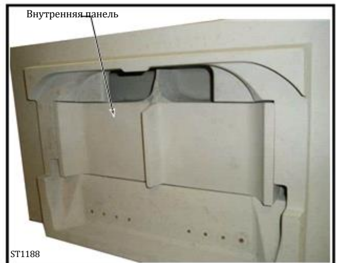
Рис. 28 Снимите внутреннюю панель
