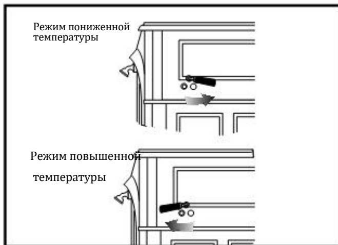
Рис. 31 Ручку также можно устанавливать на промежуточный уровень между двумя режимами.
