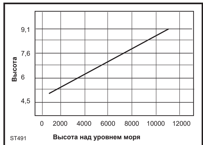
Рис. 2 Требуемая высота для 6-дюймовой трубы и/или для соединителя с трубой.
