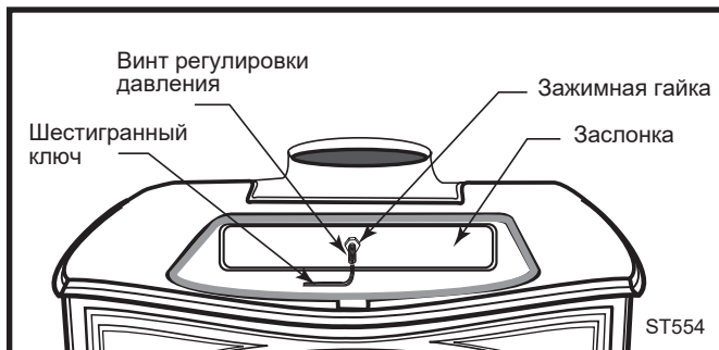
Рис. 43 Отрегулируйте заслонку шестигранным ключом.
