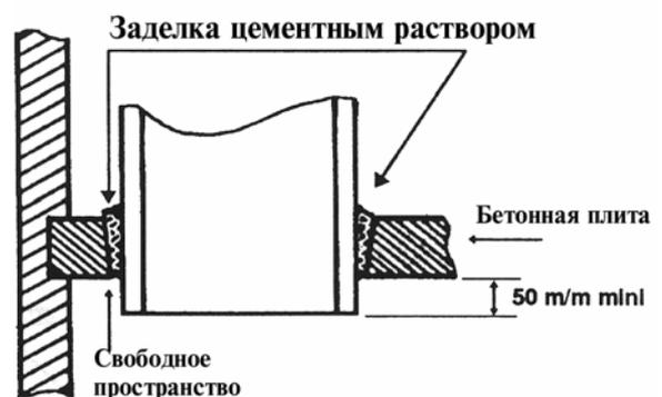
оставлять вокруг дымохода свободное пространство, достаточное для установки кожуха, делающего возможным свободное тепловое расширение дымохода; кожух изготавливается из негорючего материала (класс М0).
