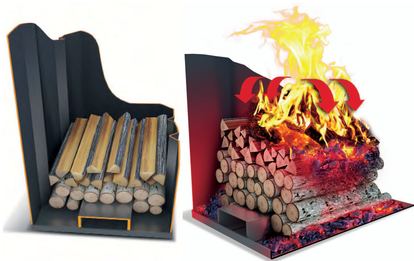
Рисунок 9.5. Варианты закладки дров в топку печи.
