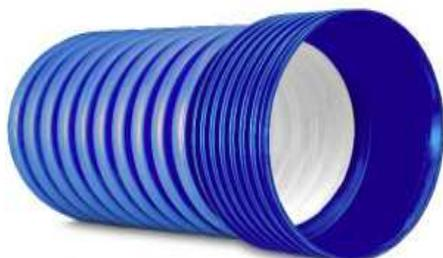
Гофрированные трубы ТЕХСТРОЙ® из полипропилена и полиэтилена с двухслойной стенкой, изготовленные методом соэкструзии двух стенок, формирующих трубу. Трубы имеют наружный гофрированный (профилированный) слой и гладкий внутренний слой. «Техстрой» первая компания в России использующая инновационный метод формирования раструба, разработанный компанией IPM (Италия). Данный метод предполагает формирование раструба на гофрированной двухслойной трубе методом литья под давлением, т.е. без сварного шва.
