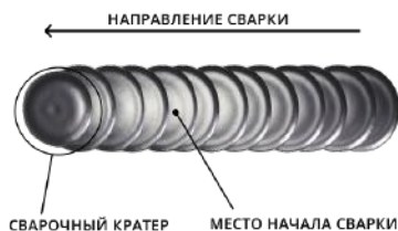
Рис. 12.4. Начало сварки при смене электрода.
