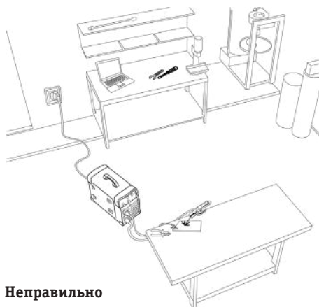
Рис. 8.4. Подключение оборудования к электрической сети.
