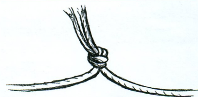
Рис.22. Соединение порвавшейся нити
