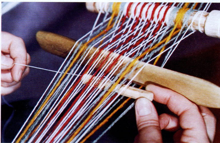
Рис.9. Перебрасывание ниченки в закрытый зев.
