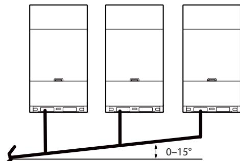
Разветвитель ниже, чем соединительный трубопровод наружного блока, а угол наклона направления составляет 0–15°
