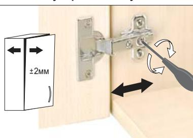
Ослабить крепежный винт и отрегулировать расстояние между дверью и боковой шкафу. Затем снова затянуть крепежный винт.
